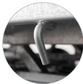
Lange Zurrhaken unter dem Ladeboden
