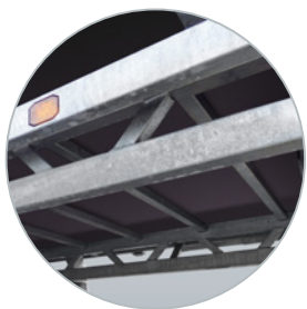
Robustes Profichassis aus Rechteckrohrprofilen
