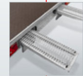
Unterm Ladeboden integrierte Auffahrampen
