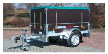
GL 1001 mit serienmäßigem leichten Stützrad und Auflaufbremse. Als Zubehör Aufsätze 600mm hoch und Flachplane in hollandgrün RAL6026 sowie Stoßdämpfer. Die Aufsätze sind bei Bedarf abnehmbar.
