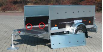
Optimale Raumausnutzung + Verzurrmöglichkeiten. Es geht kein Laderaum verloren wie bei versenkten Anbinderingen.
