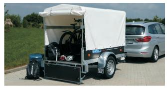
**GL 1351 mit Zubehör Dachgestell und Plane** 1000mm hoch sowie Stoßdämpfer für Zulassung 100km/h.
