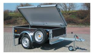
**GL 751 mit Zubehör** Thermodeckel, Rohrstützen mit einfacher Klemmhalterung, Ersatzrad mit Halterung und Stützrad leicht.
