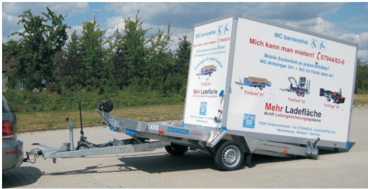
QM 1801 mit Hydraulikzylinder kippbar. Mit einer Seilwinde wird der Container WC 00 für den Transport hochgezogen und anschließend an den Vermietungsort gebracht.
